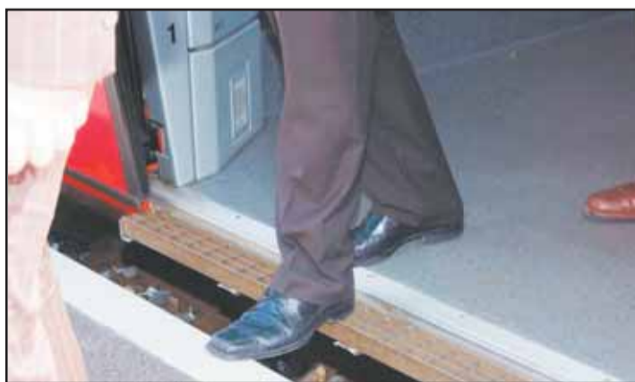
La construction de nouveaux quais à hauteur de 55 cm permet un accès au train facilité, notamment pour les personnes à mobilité réduite. MAILLARD
