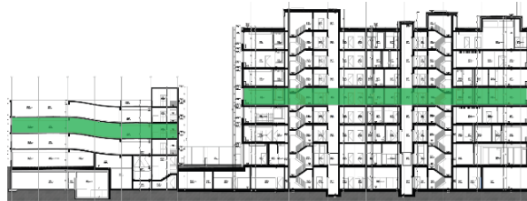
Bürogebäude mit einem zusätzlichen Stockwerk und Parkhaus mit zwei zusätzlichen Halbetagen
