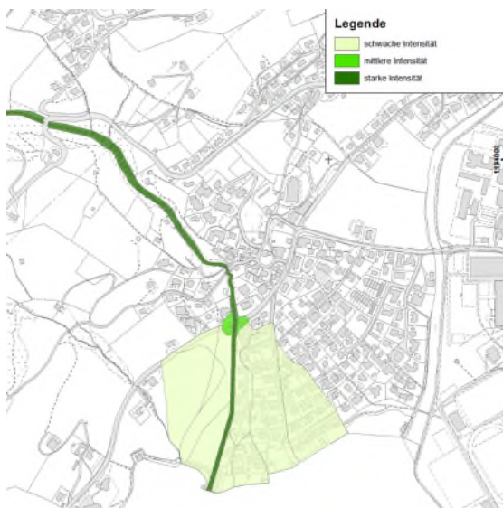
Abbildung 6: Überflutungsintensitäten vor Massnahmen ausgehend vom Blattibach für ein 100-jährliches Ereignis.
