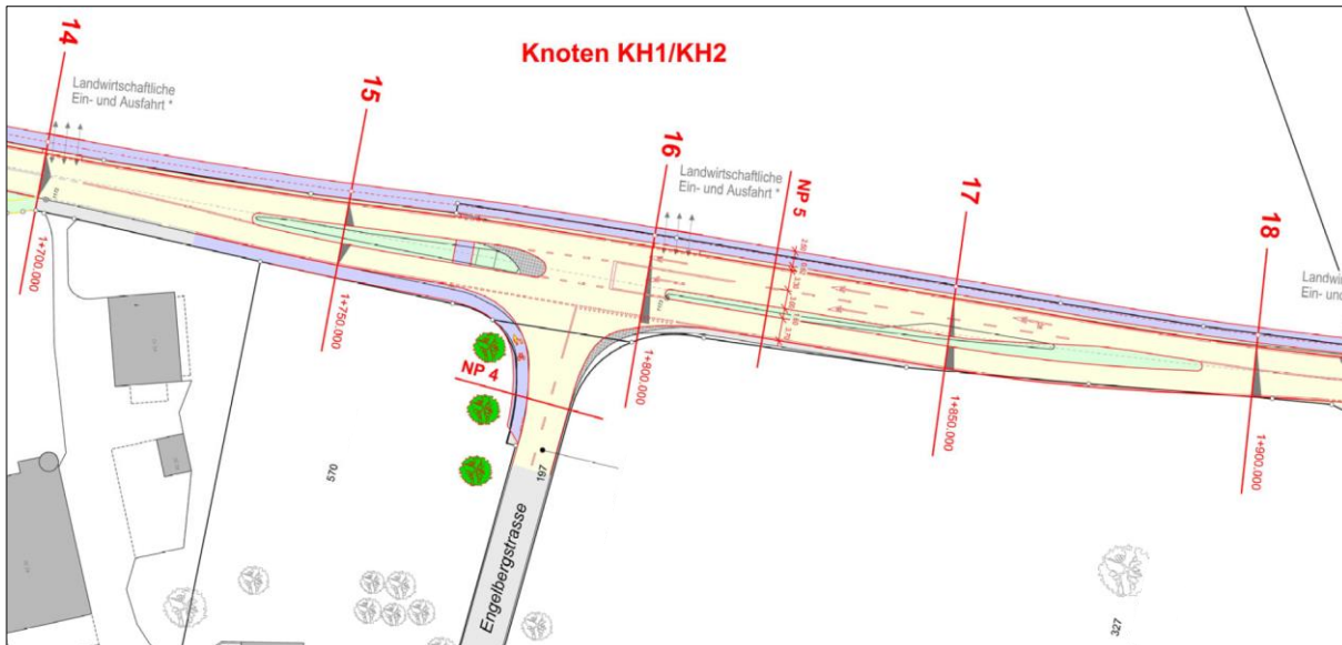
Abbildung 10: Schematische Darstellung der geplanten Anpassungen am Knoten KH1/KH2
