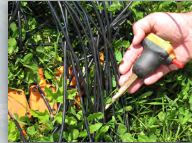
Geophone registrieren die an der Oberfläche ankommenden reflektierten Schallwellen
