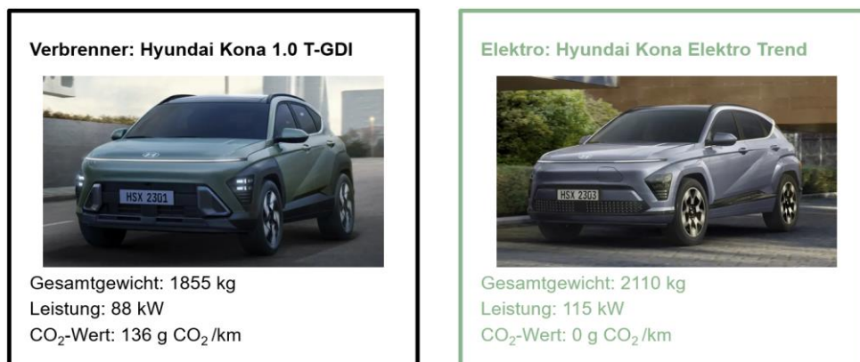
Abbildung 4. Hyundai Kona mit Verbrennungsmotor (links) und als Modell mit elektrischem Antrieb (rechts). Das Modell mit elektrischem Antrieb weist ein Mehrgewicht und eine Mehrleistung gegenüber dem Verbrennungsmodell auf. Quelle: https://www.adac.de
