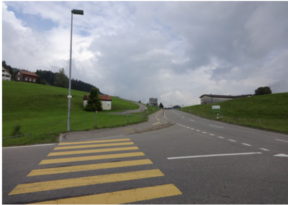
Bild 15: mit wenig Mitteln zu behebbende Schwachstelle im Langsamverkehr an der Strecke Waldstatt - Schönggrund: absenken der Randsteine und Änderung der Markierung für Radfahrende.
