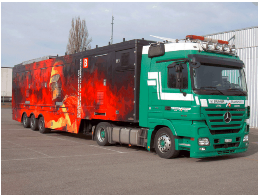
Mobile Brandsimulationsanlage auf Sattelzug.
