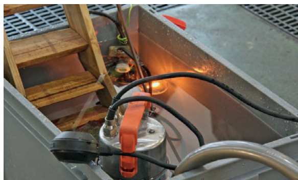
Simulation: Eine mit Wasser gefüllte Kunststoffbox eignet sich für die eindrückliche Demonstration der Gefahr einer Spannungsverschleppung in einem überfluteten Keller.
