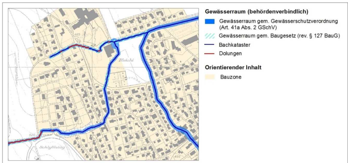
Abbildung 11: Berechnung des Gewässerraums auf Basis des Bachkatasters und der Ökomorphologie
