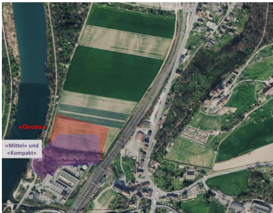
Abbildung 27: Situation Luftbild ungefähre Flächenausdehnung Varianten «Mittel», «Gross» und «Kompakt» (Quelle: Konzeptstudie ARA Seetal, Holinger 2017)
