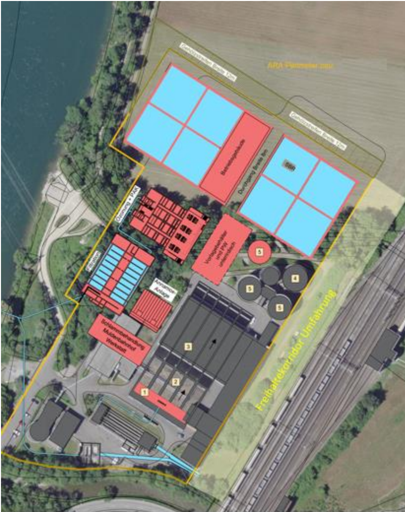
Abbildung 2: Layout der ARA Seetal nach dem Zusammenschluss (233'000 Einwohnerwerte), Variante 2
