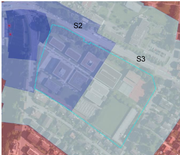
Abbildung 3: Gewässerschutzzonen S2 und S3
