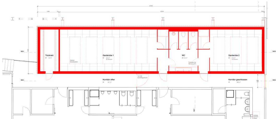
Abbildung 7: TP2 - Grundriss Obergeschoss (rot = Neubau)
