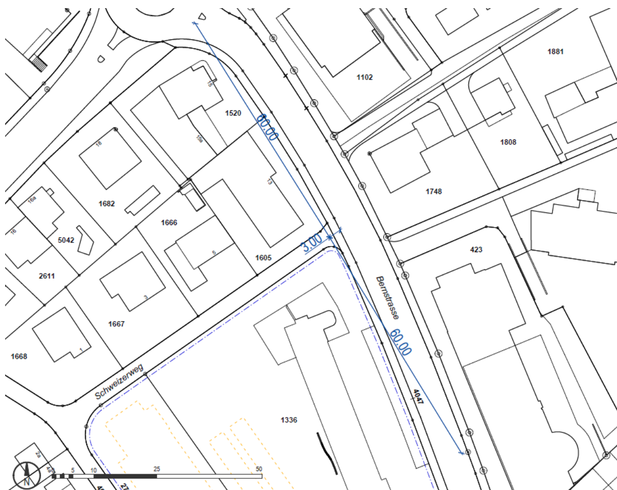
Abbildung 8: Sichtweiten Anschluss Schweizerweg / Bernstrasse - motorisierter Verkehr (60 m)
