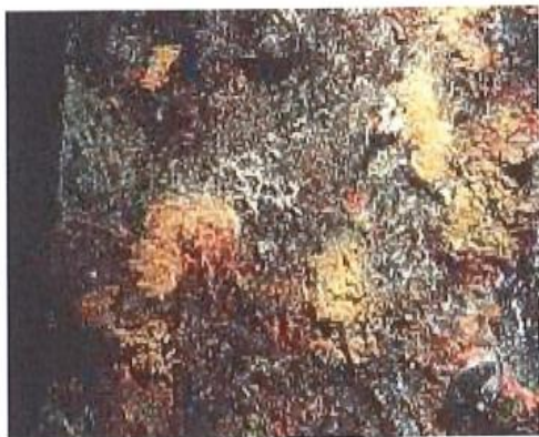
Unbehandelte Stahlführungsschiene mit starker Rostbildung und Bewuchs (Muschel)
