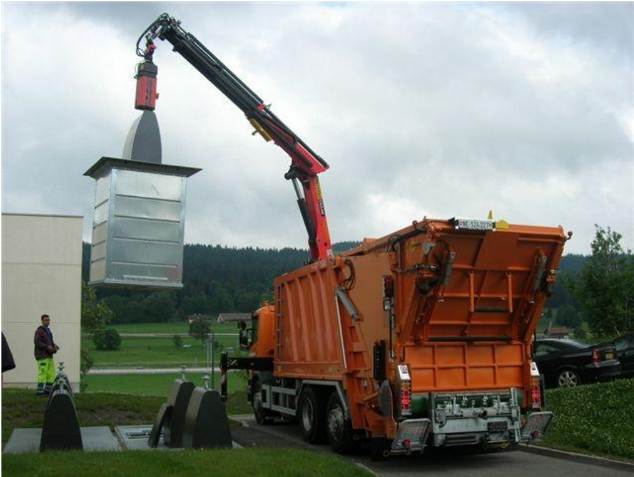
Camion poubelle pour conteneurs enterrés avec grue en action
