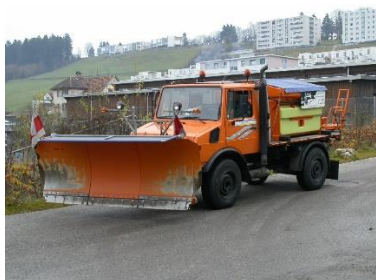
Véhicule équipé pour le déneigement
