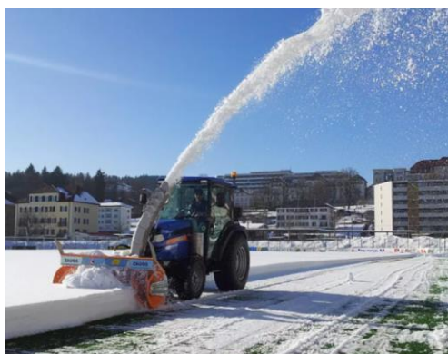
Véhicule équipé pour le déneigement
