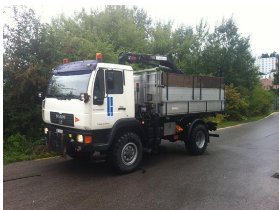
Camion à pont basculant 2 essieux
