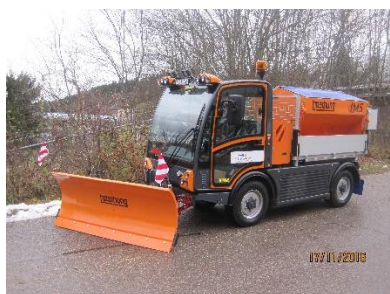
Véhicule équipé pour le déneigement
