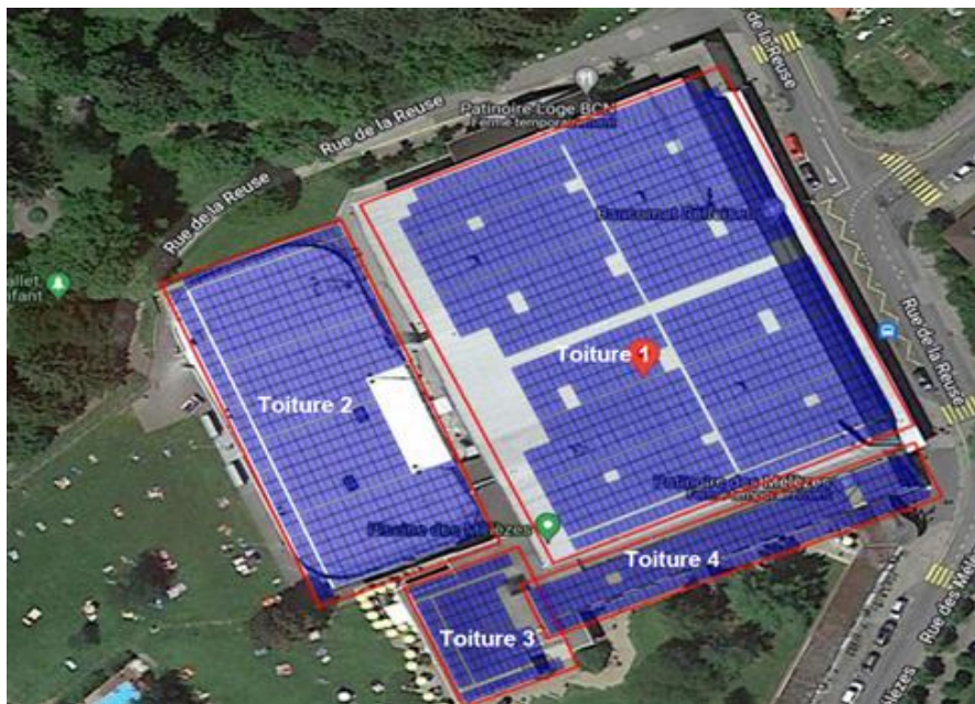
Vue aérienne : toitures des bâtiments et disposition des modules solaires.
