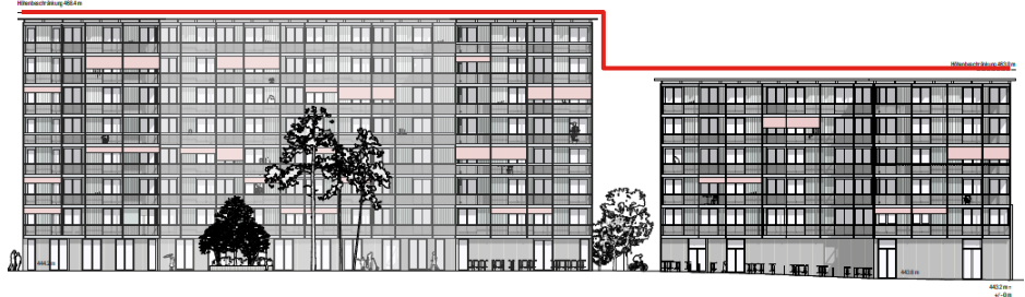
Abbildung 72 Bauhöhenbeschränkung (rote Linie) im Teilgebiet Süd
