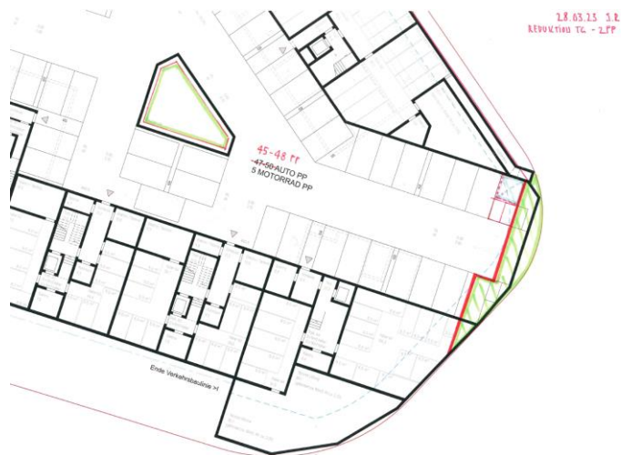
Abbildung 70 Skizze Reduktion Tiefgaragen Abstellplätze
