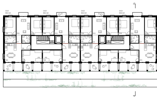
Grundriss Typ S - 5-6. Obergeschoss 1:200
