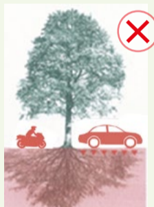
Compactage (même épisodique)
