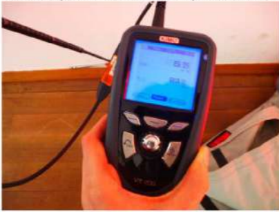
N.9 Perdita diffusa su tutto il profilo della zoccolatura – Valore perdita: 5,5 m/s
