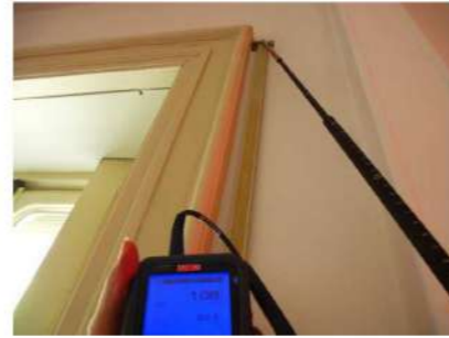
N.8 Perdita guida tapparella – Valore perdita: 1,08 m/s
