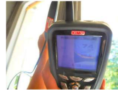
N.9 Perdita profilo cassonetto – Valore perdita: 7,4 m/s
