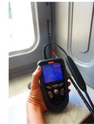
N.2 Perdita cerniera inferiore serramento – Valore perdita: 0,47 m/s
