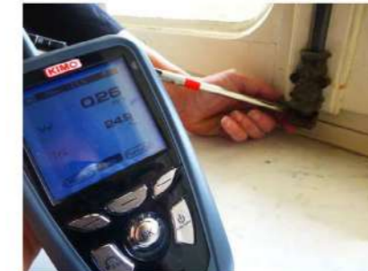
N.2 Perdita telaio apribile in corrispondenza del raccordo con la parete- Lato sx – Valore perdita: 0,63 m/s
