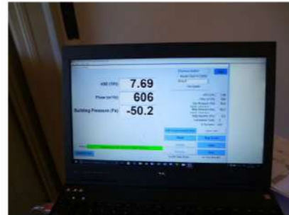
Immagine 4 – parametro n50 ottenuto a seguito delle sigillature dei vani alloggio tende a rullo
