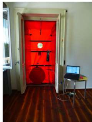
Fig.3 Immagine dopo il montaggio del ventilatore sulla portafinestra – Interno
