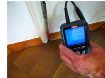
N.1 Perdita in corrispondenza della specchiatura lignea della porta interna - Valore perdita: 0,59 m/s
