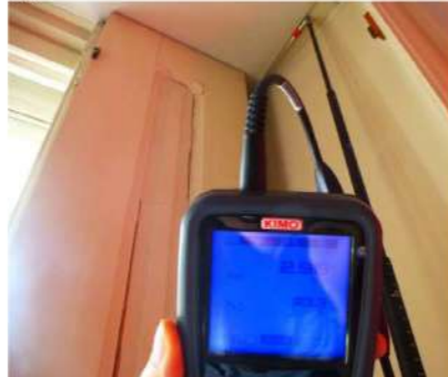
N.17 Perdita profilo cassonetto – Valore perdita: 2,96 m/s
