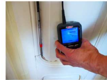
N.1 Perdita in corrispondenza della specchiatura lignea della porta interna - Valore perdita: 0,59 m/s
