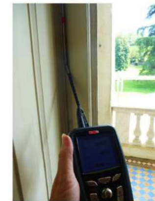
N.2 Perdita telaio apribile in corrispondenza del raccordo con la parete- Lato sx – Valore perdita: 0,63 m/s
