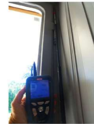
N.1 Perdita cerniera superiore serramento – Valore perdita: 4,5 m/s
