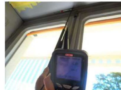
N.8 Perdita profilo cassonetto – Valore perdita: 4,2 m/s
