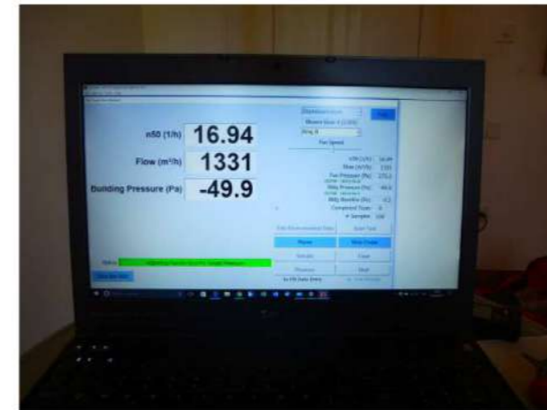
Foto 1 – Risultato prova preliminare
