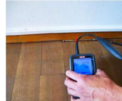
N.18 Perdita diffusa su tutto il profilo della zoccolatura – Valore perdita: 2,79 m/s
