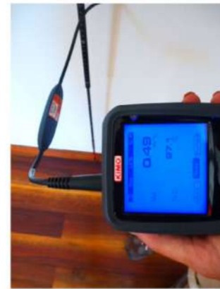
N.6 Perdita zoccolatura – Lato interno – Valore perdita: 0,49 m/s
