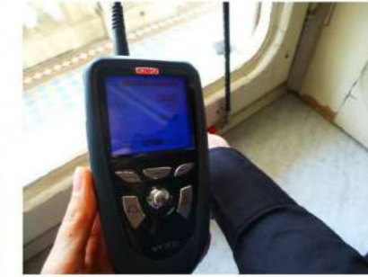
N.12 Perdita telaio apribile in corrispondenza del traverso inferiore: 3,2 m/s
