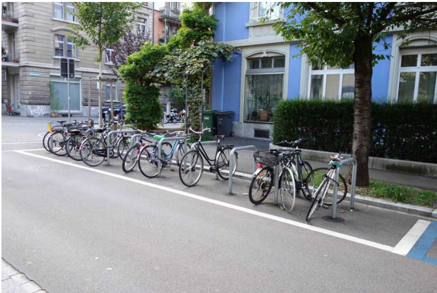
Esempio di area di sosta per biciclette a Zurigo. Gli archetti necessitano di spese di manutenzione molto basse e consentono di legare il telaio delle biciclette, con conseguente riduzione del rischio di furti.
