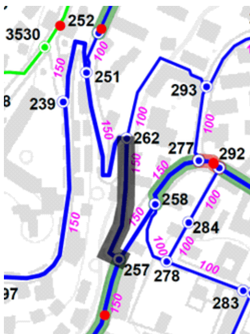
Figura 4 – Sostituzione e potenziamento condotte Via Losanna
