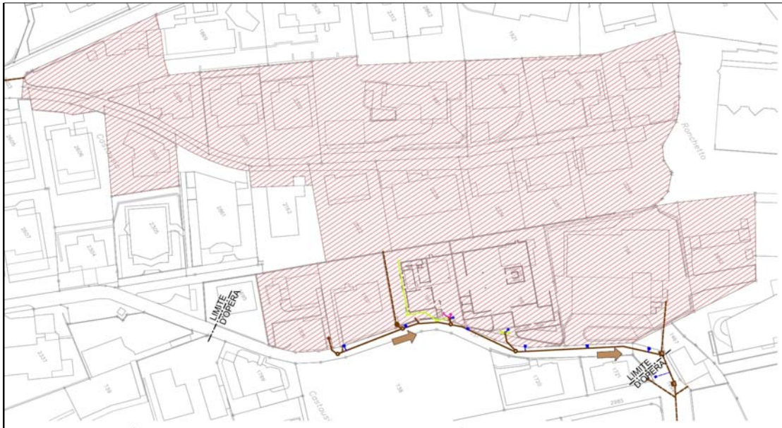
Bacino imbrifero e tratta canalizzazione da sostituire
