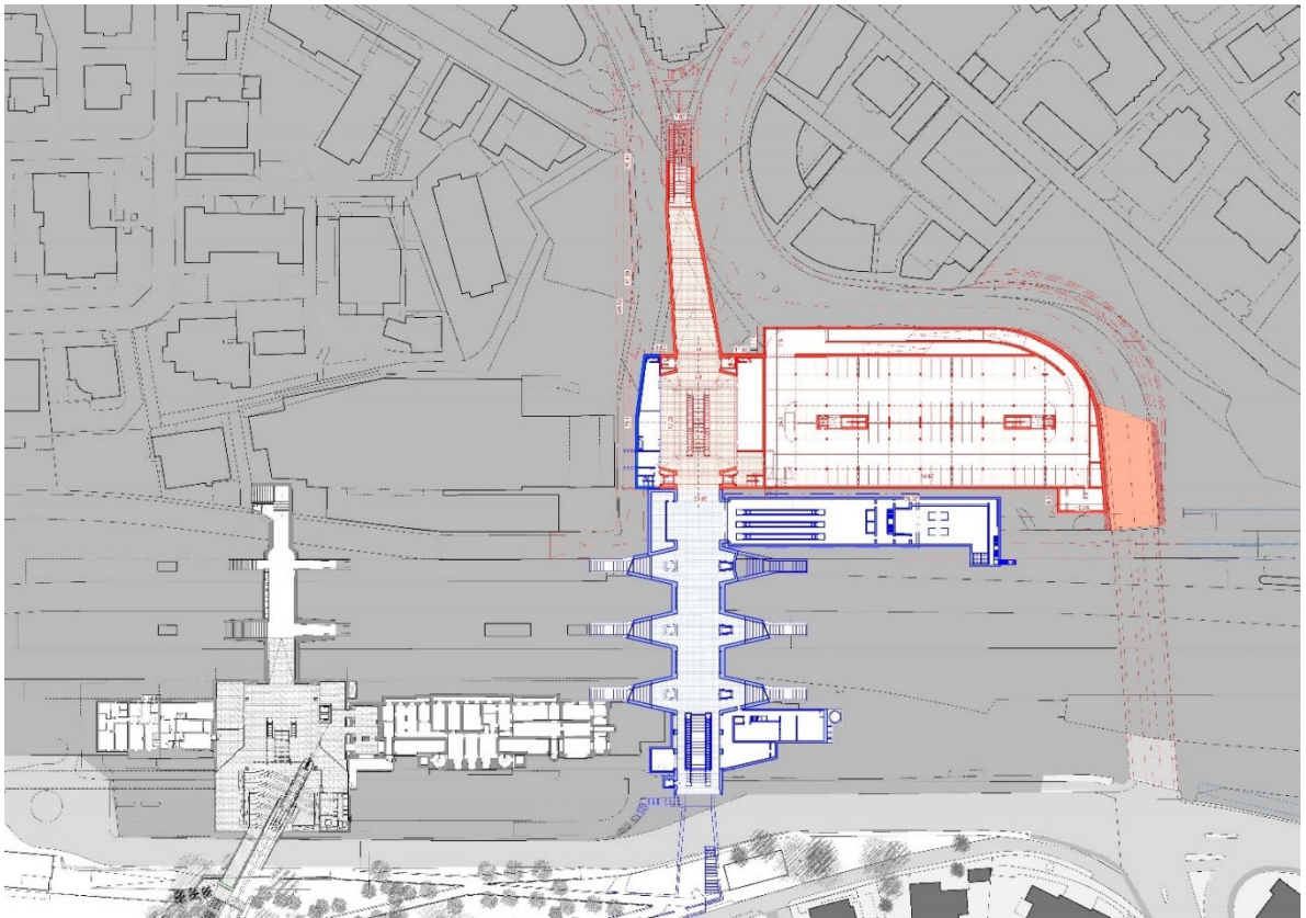
Livello -2: atrio centrale (in nero, realizzato), sottopasso di Besso (in blu, in cantiere, salvo discenderia e spazi commerciali), comparto di Besso (in rosso)
