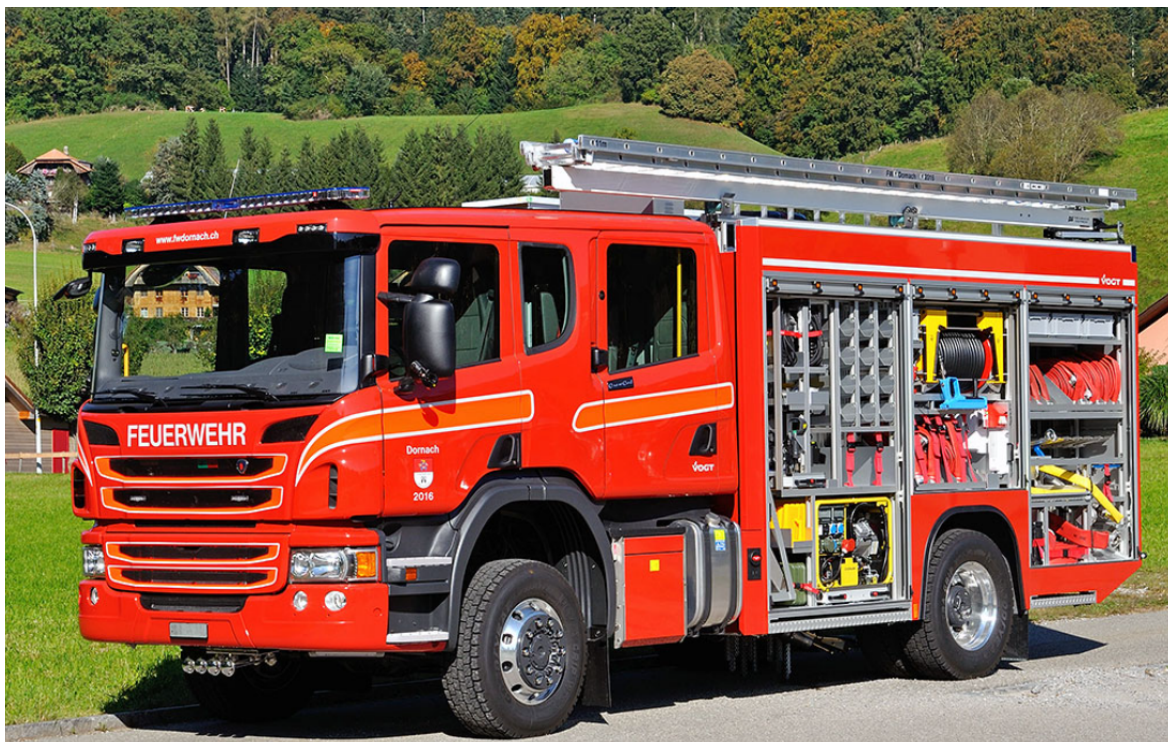
Abb. 1: Mögliches Modell und Beladung eines Tanklöschfahrzeuges TLF1 mit Doppelkabine und Allradantrieb.
