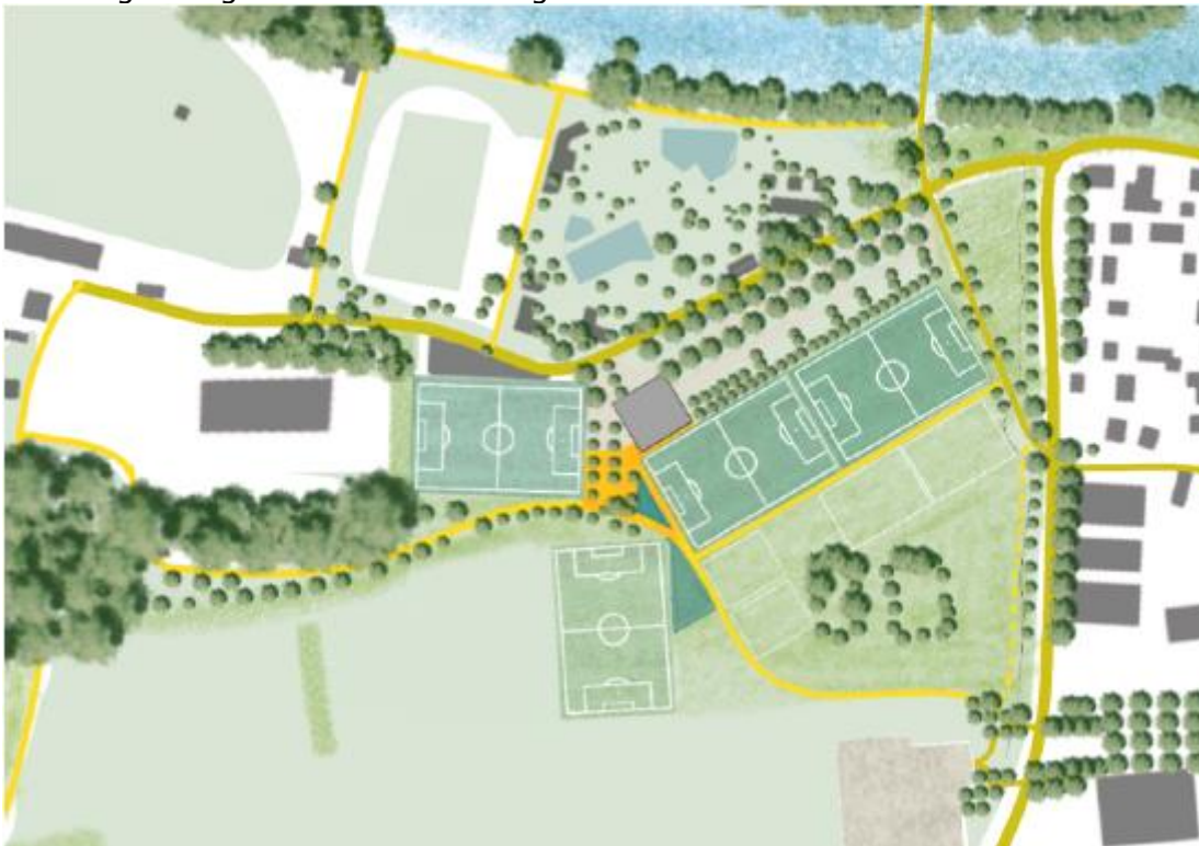
Abbildung 5: Empfehlung Freiraum und Ökologie (dunkelgrüne Fussballfelder = Kunstrasen, hellgrüne Fussballfelder = Naturrasen, Kleinspielfelder = naturnaher Bodenaufbau)
