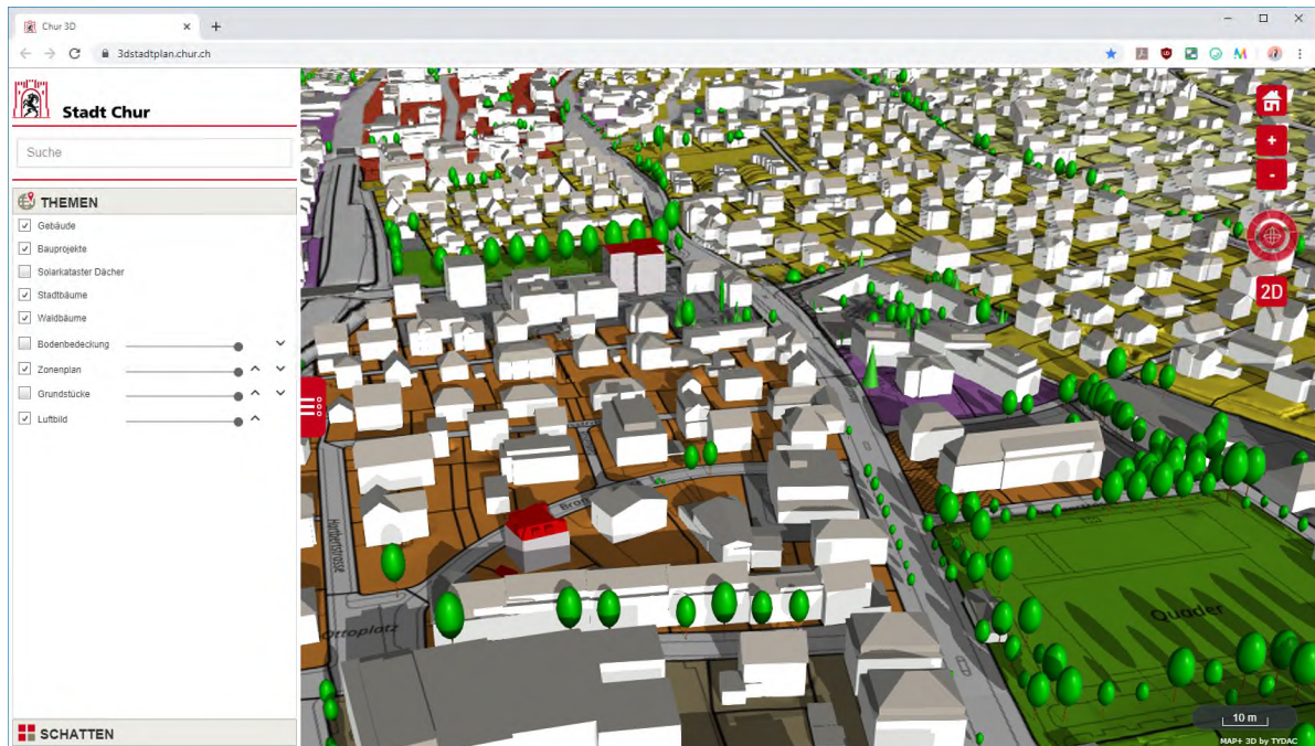
3D-Stadtplan Chur mit Zonenplan, Baumkataster, Bauprojekten (rotes Dach) und Schattenwurf für den 21. Dezember 2019, 12.00 Uhr. Ansicht der Brandisstrasse/Ottostrasse/Quaderwiese mit Blick Richtung Nord
