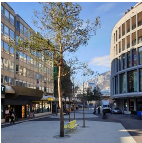
Bauminselformen mit Natursteinplatten aus Andeerer Granit
