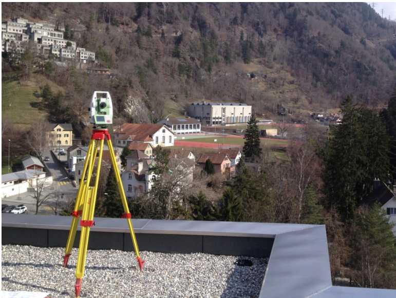
Höhenaufnahmen für eine Mobilfunkanlage auf dem Altersheim.
