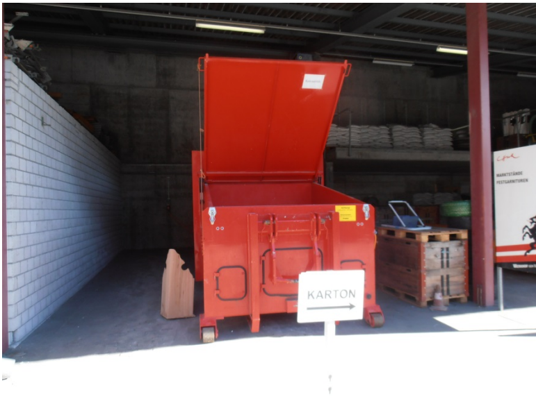
Multisammelstelle: Eine elektronische Kartonpresse ersetzt einen Kehrichtwagen.
