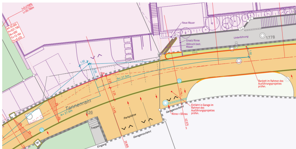
Abbildung 5: Sichtweiten Ausfahrt Autoeinstellhalle
