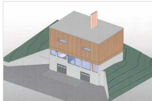
Abb. 6 Isometrie Aufstockung Heizzentrale, Stand Vorstudie (Quelle: ewb)
