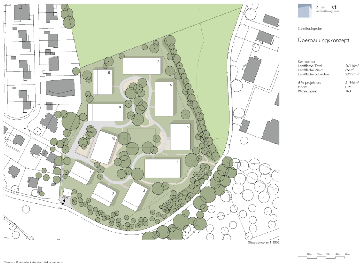
Abbildung 5: Resultierendes Überbauungskonzept Steinibachgrube
