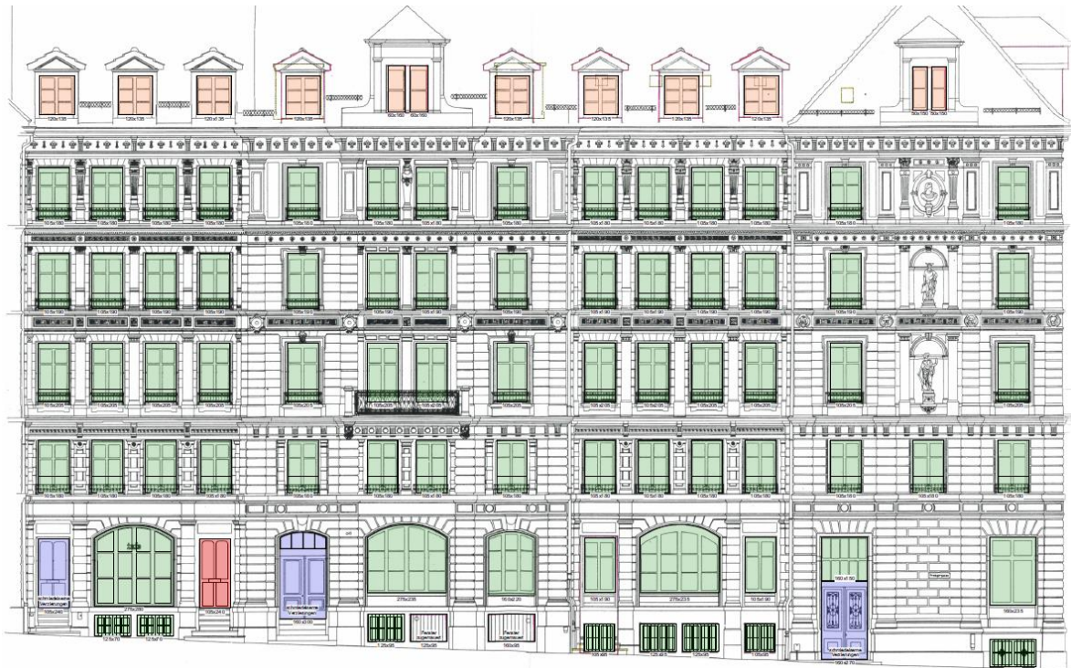
Ostfassade mit der Katalogisierung der verschiedenen Fenstertypen
