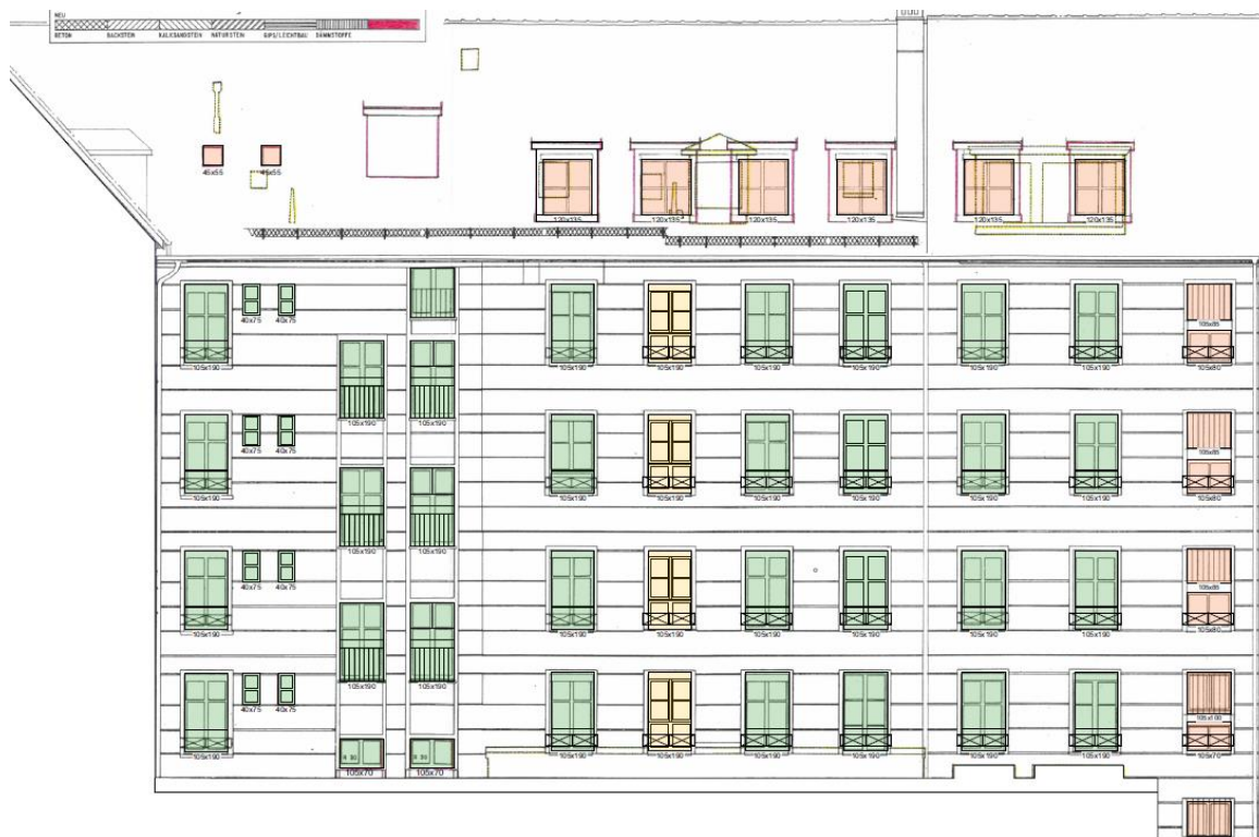
Westfassade mit der Katalogisierung der verschiedenen Fenstertypen
