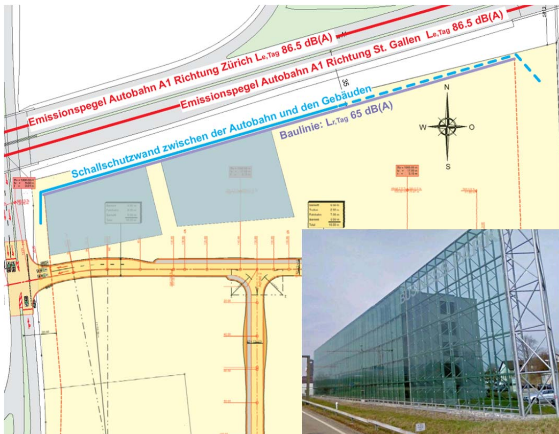
Bild: Schallschutzwand Businesspark Glattbrugg
