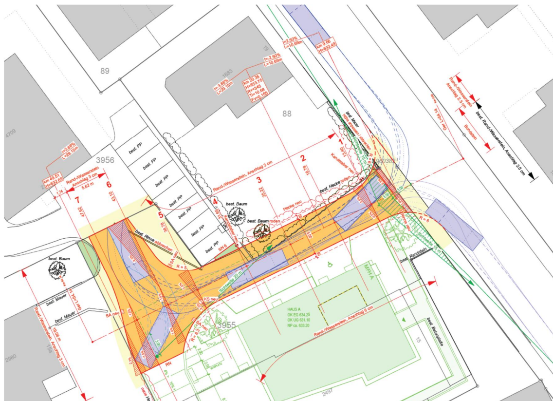
Ausschnitt Situationsplan mit Schleppkurve 8-m-Lastwagen, Wälli AG Ingenieure, 04.02.2022
