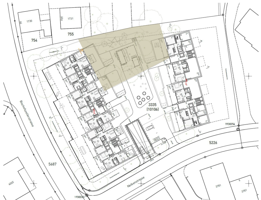
Abb. 17 Geeigneter Bereich für Transformatorstation (Hintergrundkarte: Richtprojekt, Stand 28. Februar 2025)
