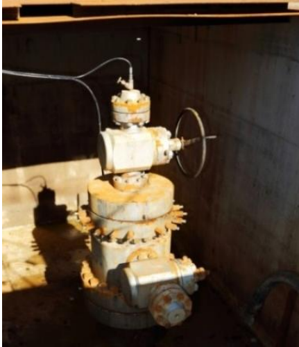
Abbildung 7: Bohrlochkopf (links) mit Drucküberwachung der einzelnen Ring- und Steigräume (rechts).
