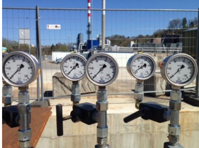
Abbildung 7: Bohrlochkopf (links) mit Drucküberwachung der einzelnen Ring- und Steigräume (rechts).
