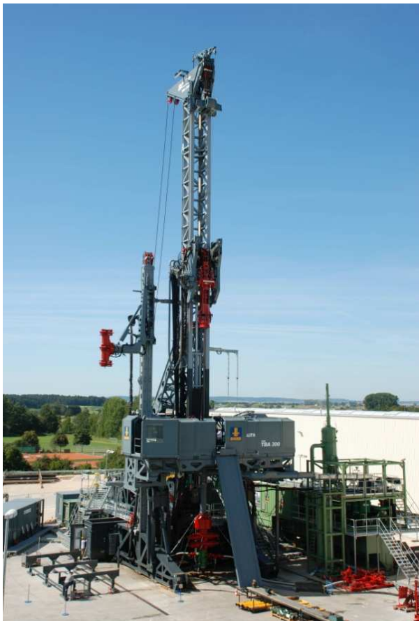
Beispiel einer Tiefbohranlage, Hakenlast 300 t, Höhe 41 m mit Gestängemanipulator und Compact-Spülsaufbereitung
