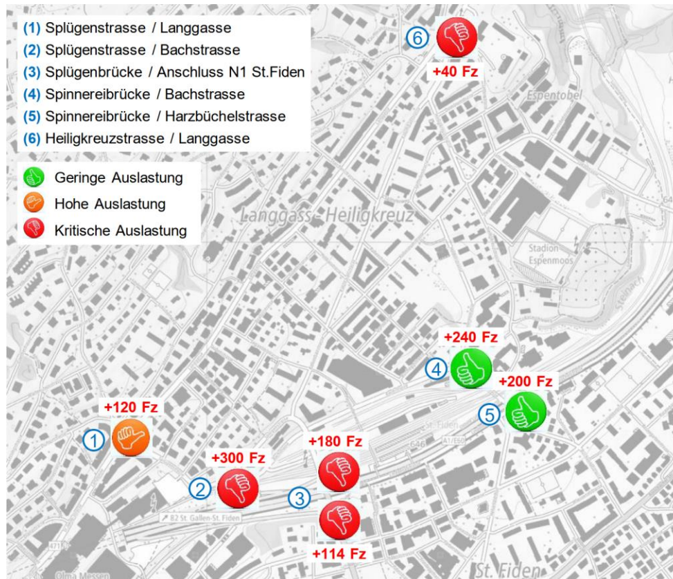
Abbildung 32: Auslastungsgrade der sechs untersuchten Knoten in der ASP im Planfall (Quelle: EBP auf Basis Detektorzahlen Stadt SG, 2017; Stauraummanagement Stadt St. Gallen, 2013)
