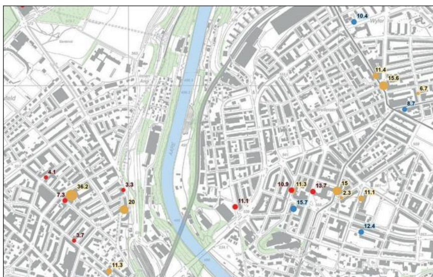
Abb. 23: Das Routing (GIS-Analyse) bringt das potenzielle Ladeaufkommen vom Hektarraster auf die Ladestandorte. Der «Localizer» berechnet nach jeder Iteration und für jeden potenziellen Standort das Ladeaufkommen und prüft, ob ein wirtschaftlicher Betrieb möglich ist (Quelle: EBP, 2022)
