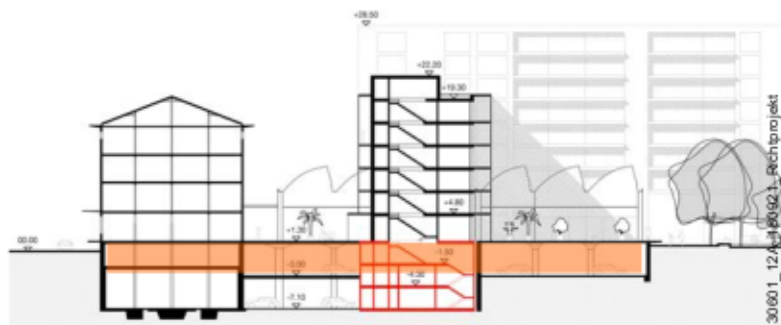
Abb. 17: Querschnitt des Richtprojekts mit Sockelgeschoss (orange eingefärbt) und Erdgeschossesebene auf ca. 290,72 m ü.M.
