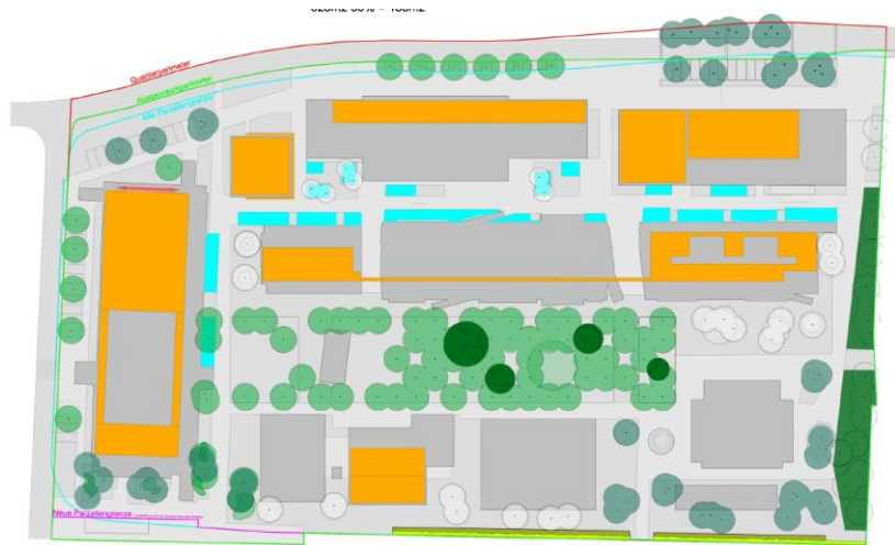
Abbildung 33 Übersicht Massnahmen zum ökologischen Ausgleich: Vernetzungsfläche (dunkelgrün), extensiv begrünte Dachfläche (orange), Hecke (hellgrün), grosskronige Bäume (grün), extensiv begrünte unterbaute Flächen (blau)
