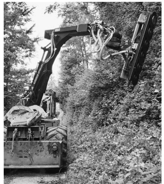
Fräse am Hydraulik-Arm mit sechs Fräsblätter
