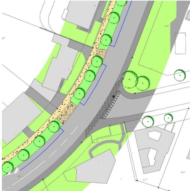
Trottoirüberfahrt einmündende Strassen Bsp. Rütiring
