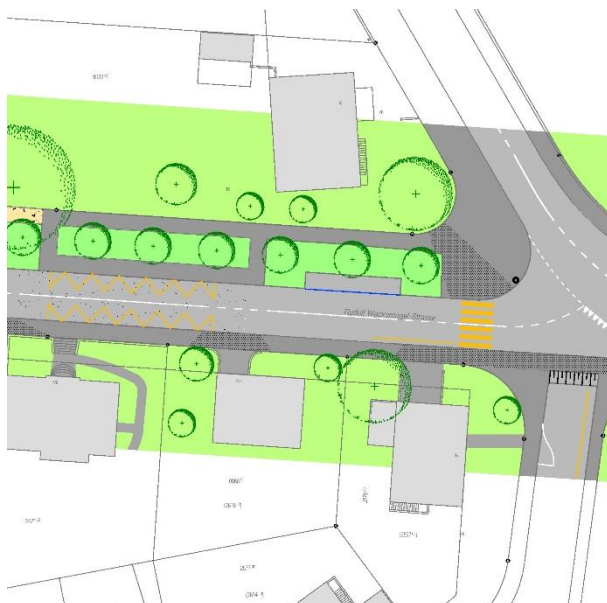
Fahrbahnhaltestellen Wenkenhof mit Haltekantenhöhe 22cm
