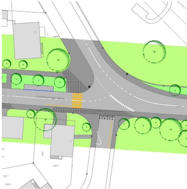
Einmündungsbereich Bettingerstrasse mit Fussgängerstreifen und Trottoirüberfahrt
