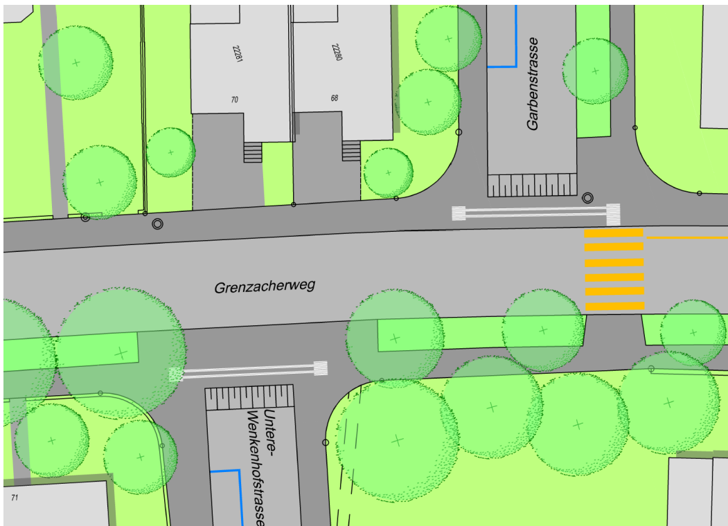
Trottoirüberfahrten Garbenstrasse und Untere Wenkenhofstrasse
