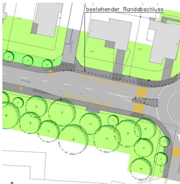
Richtung Kreisler: Fahrbahnhaltestelle mit einer Haltekantenhöhe von 22cm / Richtung Otto Wenk-Platz: Haltebucht mit teilweiser Haltekantenhöhe von 22cm
