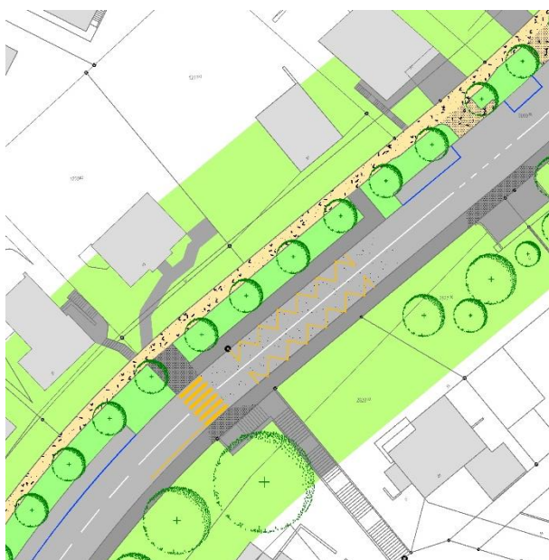
Fahrbahnhaltestellen Am Hang mit Haltekantenhöhe 22cm
