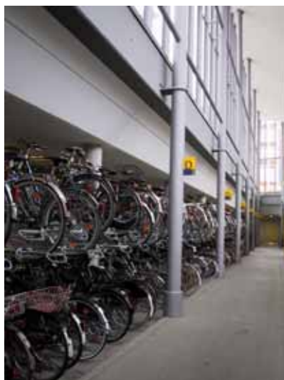
Velostation mit 3'300 Veloabstellplätzen System Doppelparker, Rampe mit 13% Neigung
