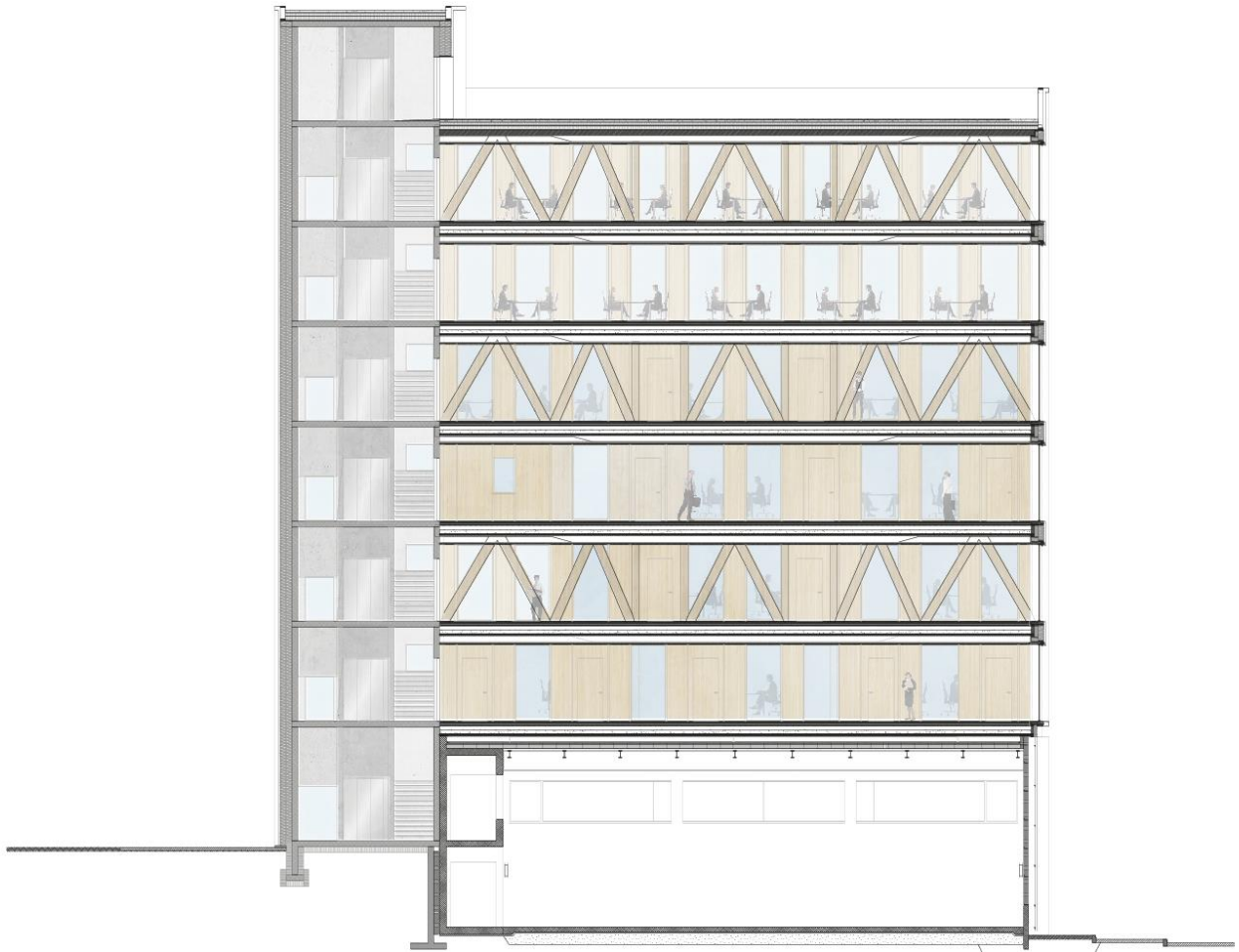
Figure 8 La coupe avec les poutres triangulées
